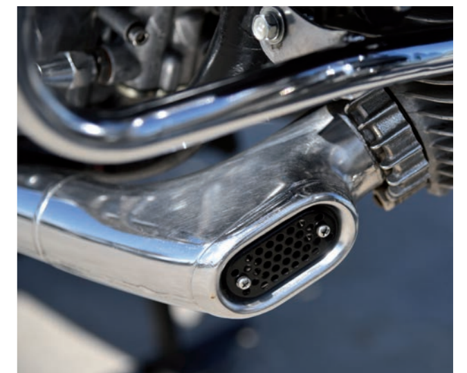
Die imposante Silhouette der Wankel-Suzuki wird vom grossen Wasserkühler dominiert. Für eine gute Kühlung sind die Auspuffkrümmer doppelwandig und mit Lufteinlässen versehen.
