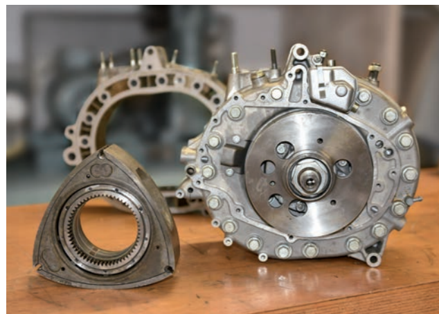
Rotationskolben, Trochoide und rechts die Wankleinheit.
