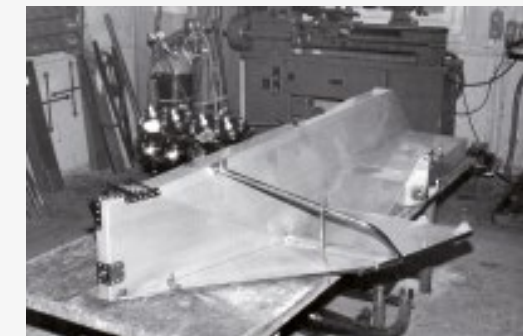
Eines der ersten LCR-Seitenwagenchassis. Der 4-Zylinder-Reihenmotor stammte von Yamaha, 1977.
