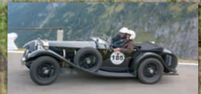
Der Invicta S-Type low chassis wird von einem 6-Zylinder-Motor angetrieben. Ein Wagen dieses Typs gewann 1931 die Rallye Monte Carlo.
