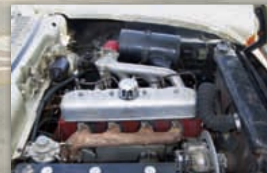
Bild oben: Dieser 56er Ford Fairlane 500 wird von einem tschechischen AVIA-712-Dieselmotor angetrieben. Bild unten: Der zum Fairlane gehörende Motor
