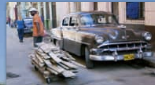
Ein grosses Problem in Kuba sind die fehlenden Transportmöglichkeiten sowohl für Personen als auch für Waren. So werden häufig solche kleinen Wägelchen gebastelt. Als Räder dienen ausranierte Kugellager.
